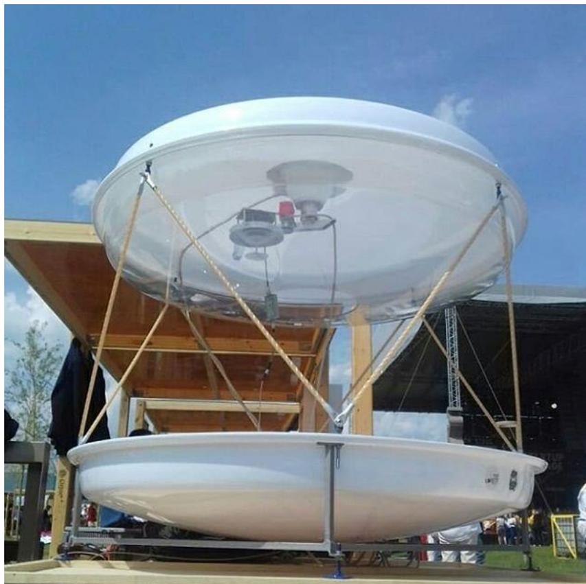
Предназначена для приема, демодуляции, декодирования, регистрации и обработки цифровой информации, передаваемой с борта КА, находящегося на низких околоземных орбитах, по радиоканалам X-диапазона частот в диапазоне скоростей демодуляции.
