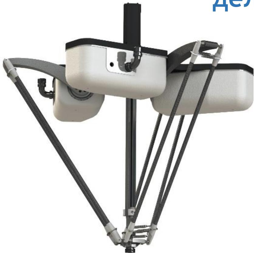
Предназначен для разработки гибких модульных автоматизированных линий на основе манипуляционных РТК, устанавливаемых над конвейерными линиями. Как правило, применяются в задачах упаковки и сортировки продукции, перемещаемой с помощью конвейерных линий.
